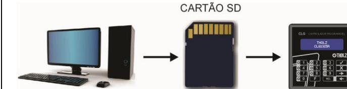
Quando o projeto desenvolvido no software Ladder – Tholz estiver finalizado, ele deverá ser compilado para gerar o arquivo .CLG o qual será gravado no equipamento CLG1315R. Ao final do processo de compilação, o software irá solicitar que o arquivo final seja nomeado. Este nome é necessário para depois identificá-lo no display do controlador.
