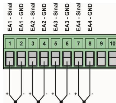
Termopar tipo J faixa: -50 a 760°C, resolução 1°C.
