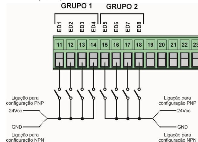
Cada grupo pode ser configurado dentre as opções NPN ou PNP. Esta configuração é realizada através do software do CLP, nas configurações de hardware:
