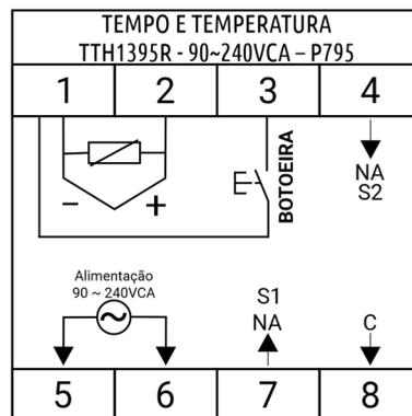
1 e 2 - Sensor de temperatura, termopar tipo J ou K, ou termo-resistência PT100. (Deve-se configurar nos parâmetros do controlador o sensor utilizado).
