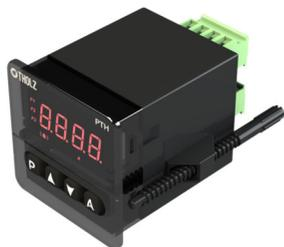
O PTH consiste em um amperímetro trifásico, capaz de indicar e monitorar correntes AC na faixa de 0 a 3kA, com o auxílio de um transformador de corrente externo (TC). A escala de corrente é configurável, aceitando diversos modelos de transformadores. Para TC's inferiores a 1000A o controlador possui indicação da corrente com ponto decimal.
