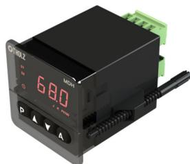
O MDH é um controlador de temperatura microcontrolado versátil e com duas saídas: uma destinada para o controle de temperatura e a outra para o alarme. O controlador possui dois modos distintos de controle da temperatura: ON-OFF ou PID. O aparelho possui também um temporizador no qual é possível controlar a temperatura por um período de tempo pré-programado.
